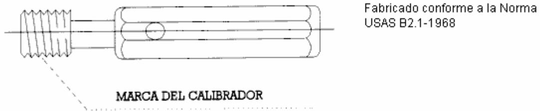
**Figura 1. Calibrador macho**
