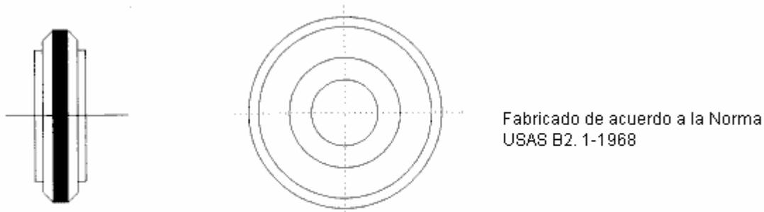
Figura 4. Calibrador hembra
